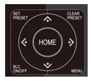
**Up**: press ▲ **Down**: press ▼ **Left**: press ◀ Right: press Return to middle position: press [HOME]
